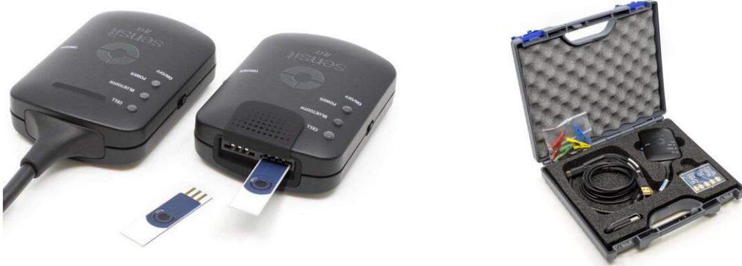
Sensit BT 非常适合用于电化学传感器应用。Sensit BT 通过蓝牙连接到您的智能手机或平板电脑，并通过安卓应用程序 PStouch 进行控制。您可以使用 USB-C 端口为 Sensit BT 充电，或者将其连接到 PC 上的 USB 端口，并通过软件 PStouch 控制 Sensit BT。
