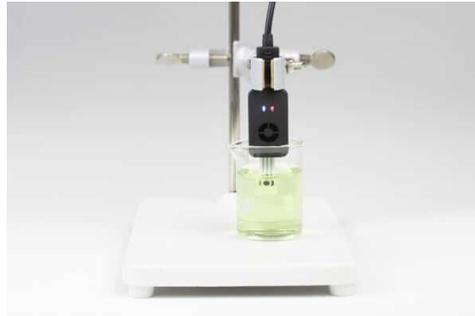
Sensit Smart 是市场上最小的即用型电位统计仪。Sensit Smart 可以直接插入智能手机或平板电脑，并通过安卓应用程序 PStouch 进行控制。您可以使用数据线将 Sensit Smart 连接到 PC 上的 USB 端口，并通过软件 PStTrace 控制 Sensit Smart。
