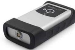
EmStat4S 在您的手掌中提供出色的性能。EmStat4S 是一款便携式 USB 供电恒电位仪、恒电流仪和可选的用于电化学阻抗谱 (EIS) 的频率响应分析仪 (FRA)。EmStat4S 由 PStace for Windows 控制, 或者您可以编写自己的 MethodSCRIPT 并从任何平台或操作系统控制它。
