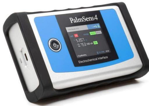
旗舰产品 PalmSens4 是一款可通过 USB 和电池供电的电化学工作站，同时可选配频率响应分析仪（FRA）用于电化学阻抗谱（EIS）分析。PalmSens4 具有宽广的电位范围（-5V 至 5V 或 -10V 至 10V）和电流范围（100 pA 至 10 mA），分辨率高且噪声低。PalmSens4 是一款经济实用的完整实验室仪器，其紧凑且坚固的设计也非常适合野外工作。通过蓝牙连接可以保证测量完全浮地。
