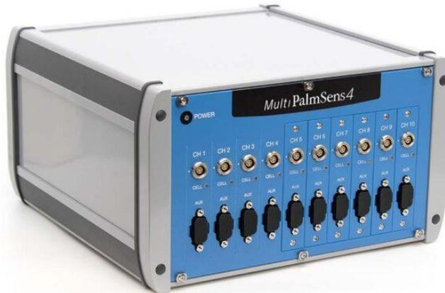
MultiPalmSens4 是一款灵活的多通道恒电位仪、恒电流仪和阻抗分析仪，您可以完全根据自己的要求和预算进行定制。MultiTrace 软件允许单独或同时使用每个通道，或在每个通道上运行一系列自动化任务。每个通道都提供一个额外的辅助端口，用于控制外设或监控温度或其他模拟信号。
