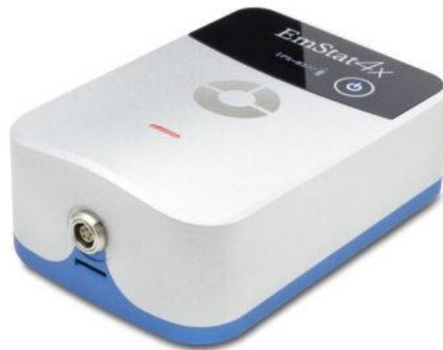
EmStat4X 在小型设备中提供高性能。EmStat4X 是一款小型的电池和 USB 供电的电位差计、电流计，同时可选配频率响应分析仪（FRA）用于电化学阻抗谱（EIS）。EmStat4X 低范围（LR）版本非常适合需要测量低至皮安的低电流的应用，如（生物）传感器研究。高范围（HR）版本则非常适用于需要最大电流高达 200 mA 的应用。EmStat4X 可通过 PStTrace for Windows 进行控制，或者你可以编写自己的 MethodSCRIPT，并从任何平台或操作系统控制它。
